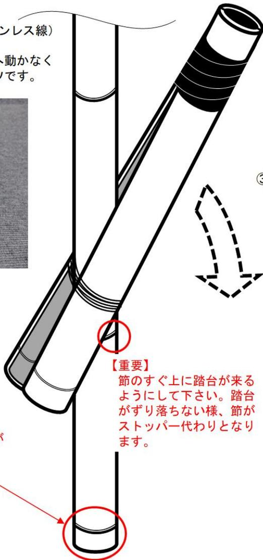
② Φ9mmくらいの針金(またはステンレス線)などで5~6回締めして下さい。しっかり締めすぎると、踏台が下へ動かなくなるので、締め過ぎないことがコツです。
